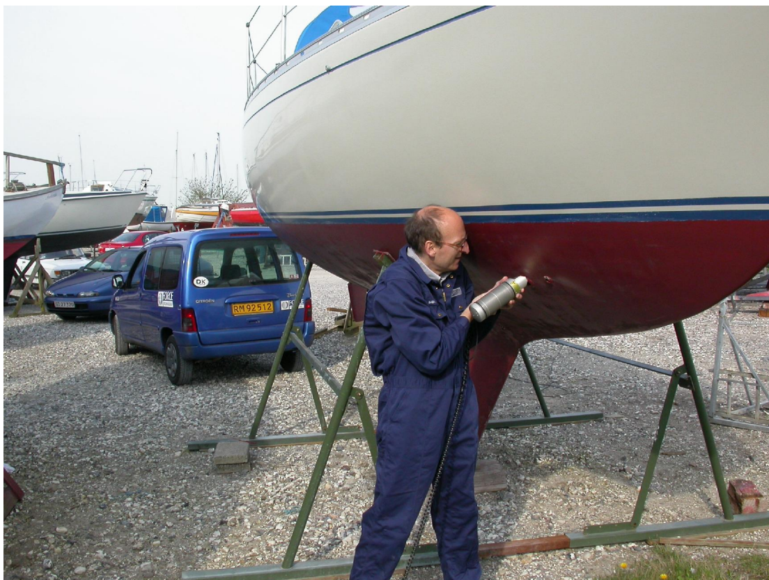
Figur nr. 5 On-site analyse af skrogennemføringer på lystbåd.
