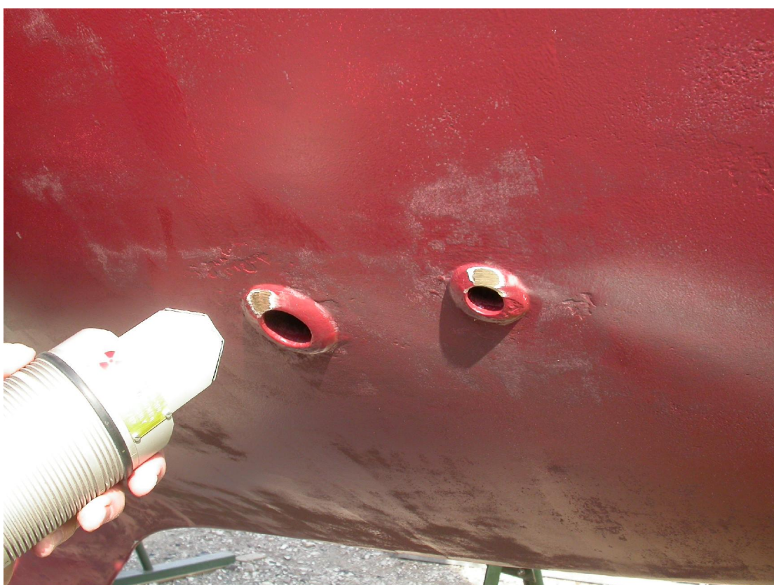
Figur nr. 6 Analysen udføres på en glatslebet flade udvendigt.
